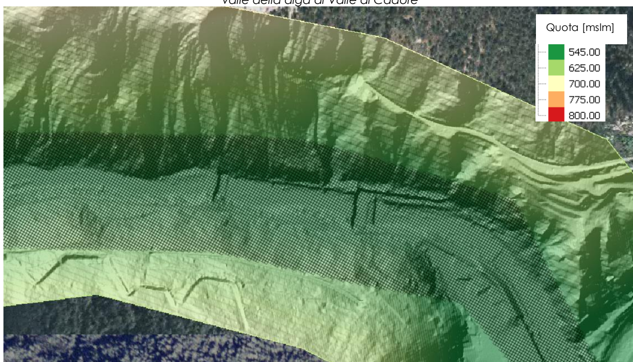
Figura 59 – Modello bidimensionale del torrente Boite e dei suoi principali affluenti vista particolare del tratto a valle della diga di Valle di Cadore
