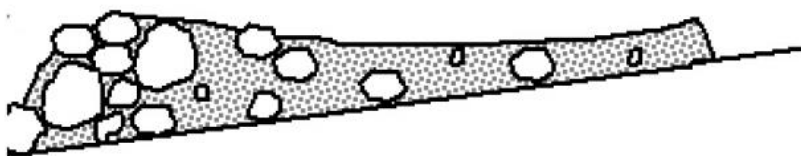
Figura 47 – Schema di una colata detritica: fronte seguito da un corpo di profondità decrescente (Gregoretti – Degetto 2012)
