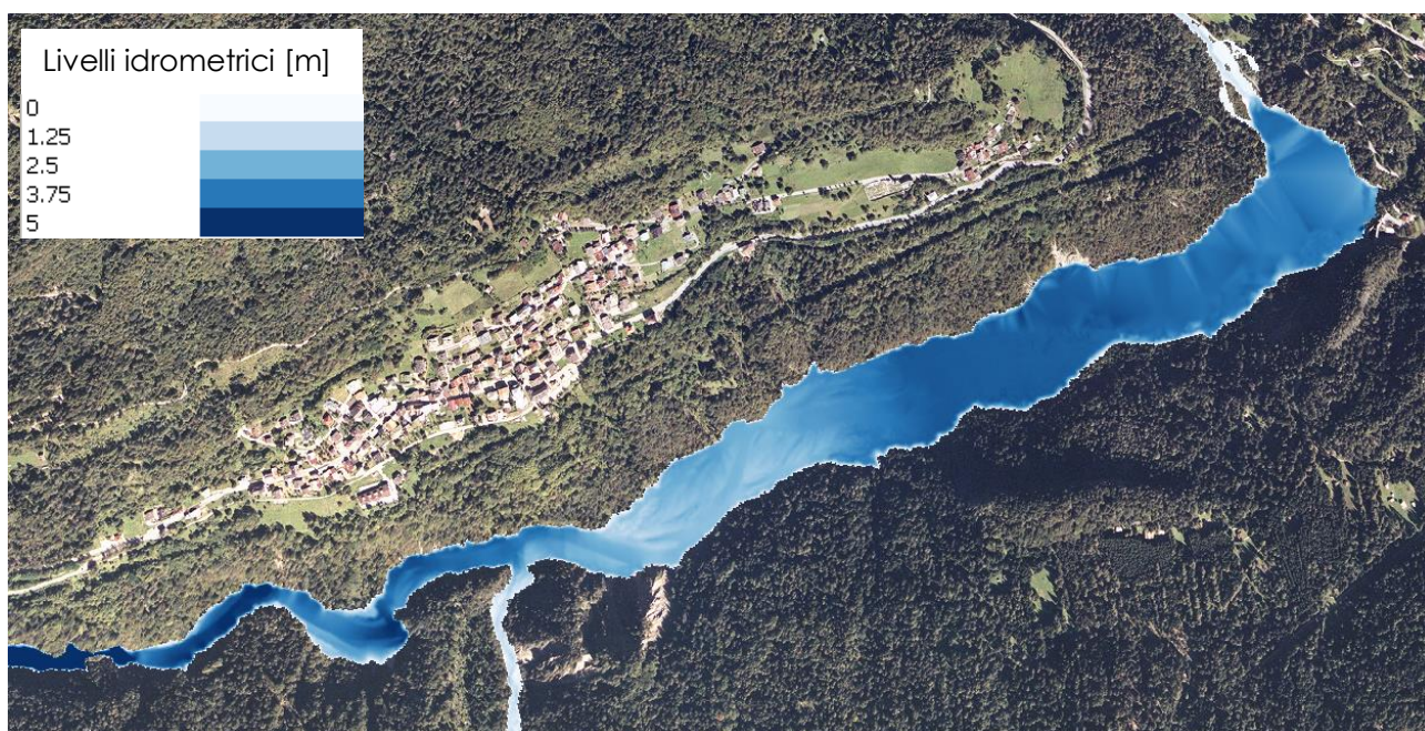
Figura 66 - Modello numerico del torrente Boite da località Peaio di Vodo di Cadore alla diga di Valle di Cadore – inviluppo dei massimi tiranti idraulici registrati in occasione dell'evento di piena con tr=100 anni
